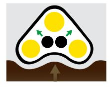
Laufwerke beim 9RX: Die innovative Bauweise mit zwei Laufrollen trägt dazu bei, dass beim 9RX Vibrationen weg von der Achse abgeleitet werden, sodass ein Fahrverhalten mit besserer Sicherheit und größerem Fahrkomfort gewährleistet ist.
