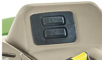
Unverzichtbar am Vorgewende: Mit dem elektrischen Schnellaushub (EQRL) können Sie Ihre Anbaugeräte bequem aus der Kabine während der Fahrt per Schalter anheben oder absenken.
