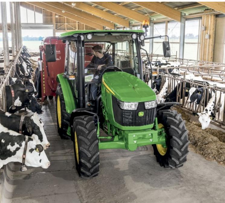
Der für das Getriebe optional erhältliche Kriechgang lässt Sie konstant bei extrem niedriger Geschwindigkeit von nur 280 m/h arbeiten.
