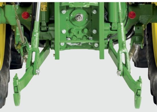
Der ultrarobuste Heckkraftheber des 5M ist selbst für schwerste Anbaugeräte ausgelegt und hat eine maximale Hubleistung von bis zu 4.440 kg (maximale Hubkraft an den Fanghaken).
