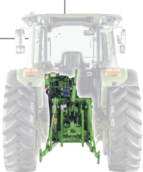
Die optional erhältliche hydraulische Anhängerbremse mit zwei Leitungen gestattet Fahrgeschwindigkeiten bis zu 40 km/h, wenn der Anhänger gemäß den neuen Vorschriften mit dem neuen hydraulischen Anhängerbremssystem ausgestattet ist.
